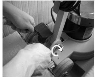
Stap 6 - Monteer de bevestigingsmoer totdat de bedieningshendel zonder speling en licht draaibaar is.
